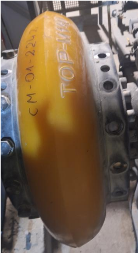
Sprzęgło na wale wejściowym
